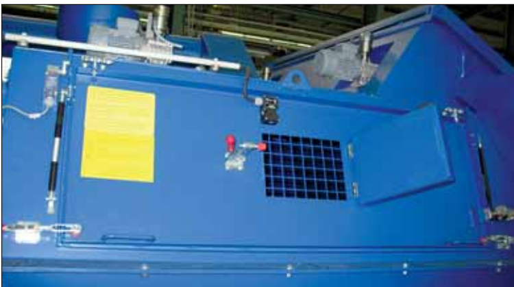
Beobachtung des Mischprozesses durch berührungsgeschützte Öffnungsklappe (Mischerreinigung optional)
