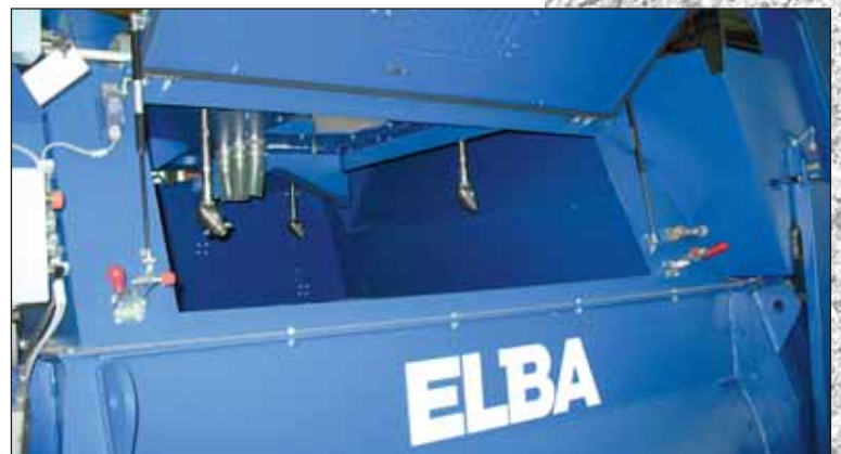
Beobachtung des Mischprozesses durch berührungsgeschützte Öffnungsklappe (Mischerreinigung optional)
