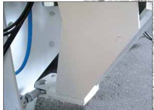
Justierbare und gelenkig ausgeführte Drehmomentabstützung zum belastungsfreien Betrieb des Getriebes Adjustable and flexible torque support for stressless operation of the gearbox
