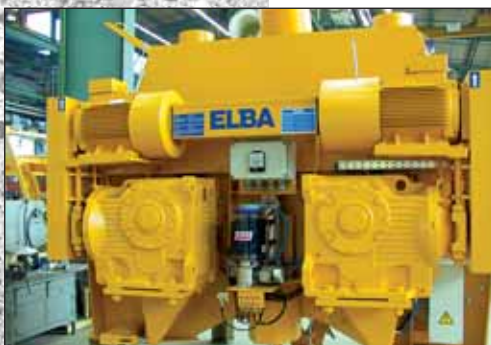
Antriebsseite EMDW 3000 Antrieb durch robuste E-Motoren, Zahnriementrieb und Kegelradgetriebe EMDW 3000 seen from the drive side. Driven by robust electric motors, toothed belt drive and bevel gear
