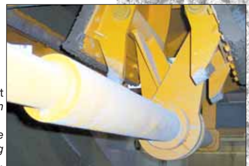
Verschluss geöffnet Discharge gate open
