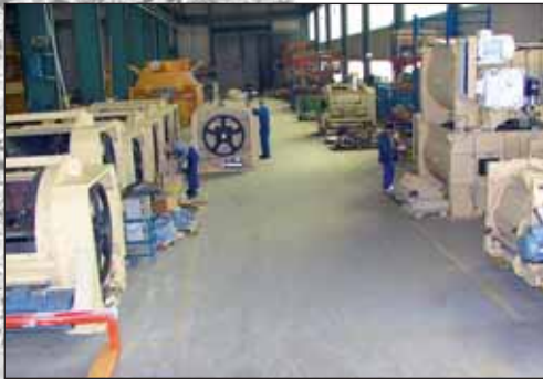
Endmontage Mischerfertigung Final assembly of mixers
