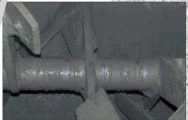
Mischerwelle vor der Reinigung Mixer shaft before cleaning
