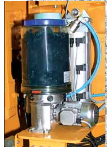
Zentrale Fettschmiereinrichtung mit Fettflussüberwachung Central greasing device with grease flow control
