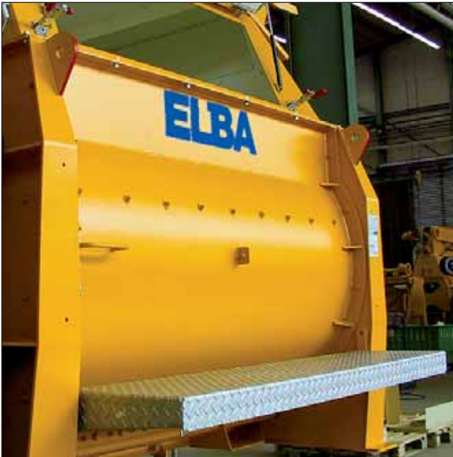
Gute Zugänglichkeit durch klappbare verzinkte Podeste.
