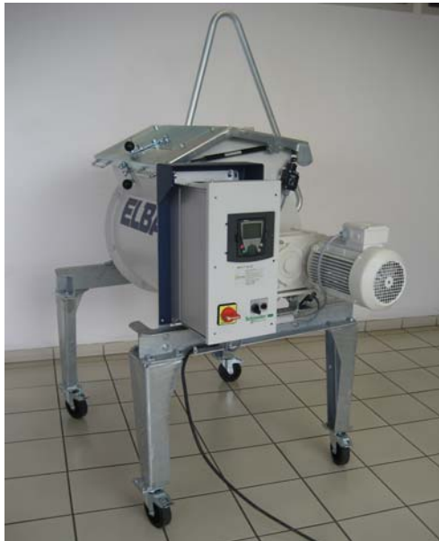
EMS 60 in Mischstellung mit geschlossenem Deckel
