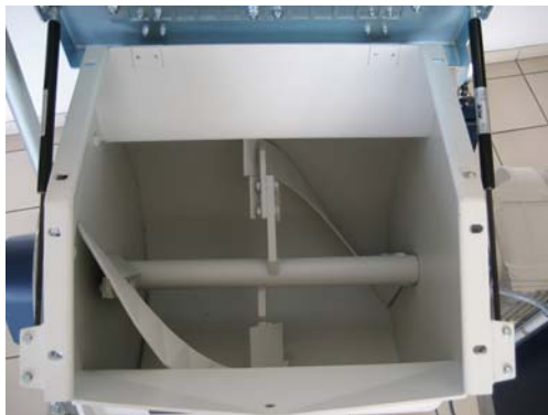
EMS 60 Innenansicht mit auswechselbarem Mischwerkzeug
